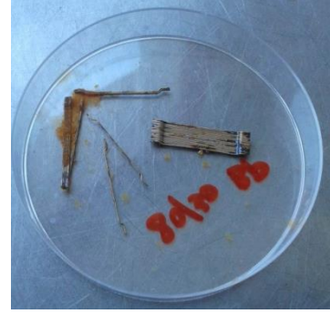
Fibre corrodibili, prova non superata
